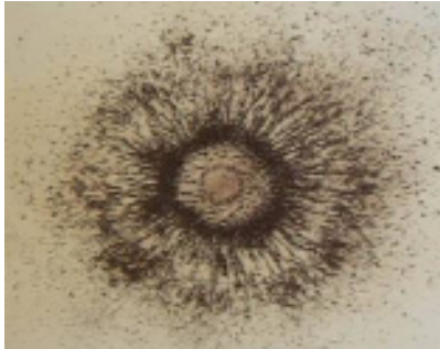
Figura 1. Campo magnético bidimensional de un imán.
